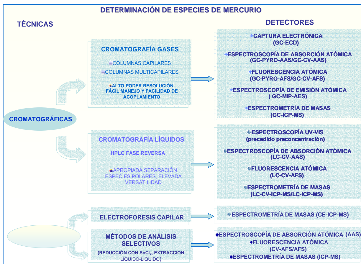
Figura 6. Resumen de las diferentes técnicas analíticas empleadas para la determinación de especies de mercurio
